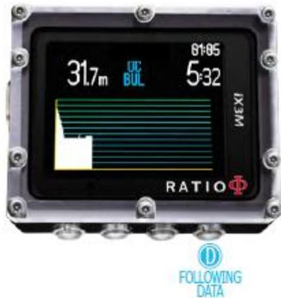
Текущая глубина: (слева) с цветным сигналом тревоги при достижении максимальной рабочей глубины MOD, время и глубина обязательной остановки
